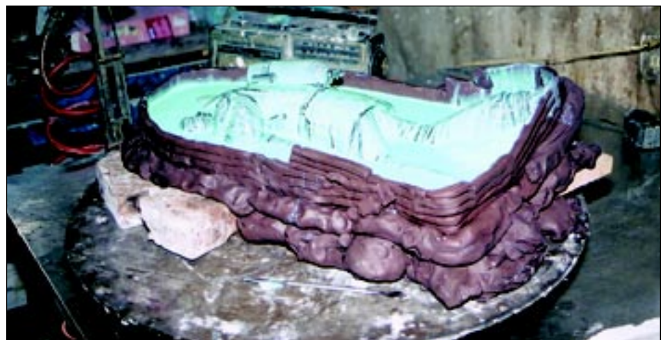
Moule en caoutchouc pour la coulée à la cire perdue.
